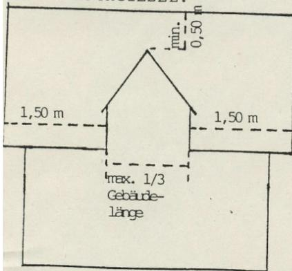
Die zulässige max. 2/3 Dachlänge wird im unteren Abschnitt der Dachfläche gemessen.
